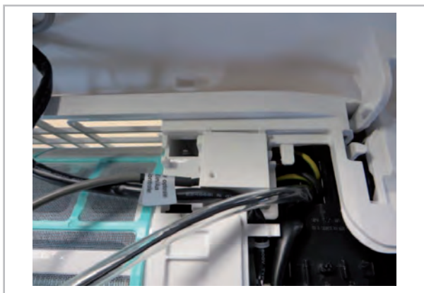
Abb. 28: Multifunktionsplatine im Gerät einsetzen
