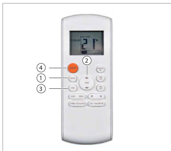
Abb. 9: Modus "Kühlen", "Heizen" und "Umluft"
