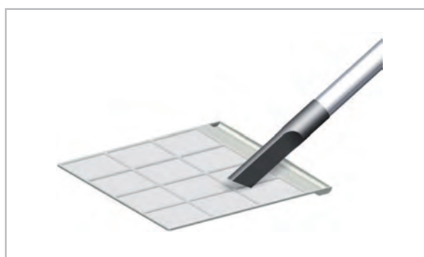
Abb. 34: Reinigung mit dem Staubsauger
