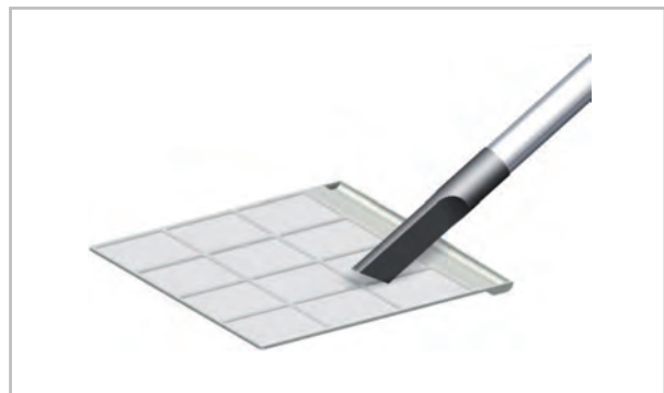
Abb. 57: Reinigung mit dem Staubsauger
