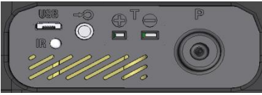
afb. 64: negatieve drukaansluiting P en temperatuuraansluiting T
