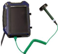
afb. 69: Wöhler A 550 met aangesloten oppervlakte temperatuurvoeler
