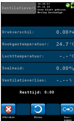
afb. 70: parameterinvoer voor de oppervlakteverliesmeting
