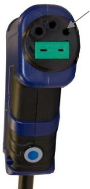
afb. 43: aansluitingen op de sondehandgreep. geleidingsbus met pijl gemarkeerd (alleen Wöhler A 550)
