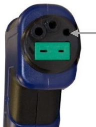
afb. 62: aansluitingen op de sondehandgreep. geleidingsbus met pijltje gemarkeerd
