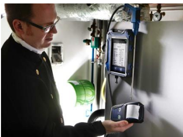
afb. 35: Afdrukken van de meetgegevens van de Wöhler A 550 op de thermoprinter Wöhler TD 100
