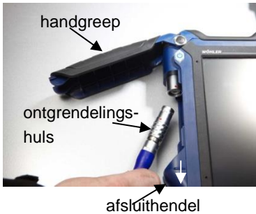
afb. 27: Wöhler A 550 met geopend sonde aansluitvak
