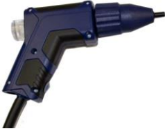
afb. 79: Sondehandgreep Wöhler A 550 met drukmetingsadapter. De slangpilaaraansluiting is geschikt voor meetslangen \varnothing 3,5 x \varnothing 6,5 mm
