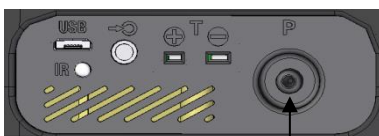
afb. 42: negatieve drukaansluiting aan de onderkant van het apparaat
