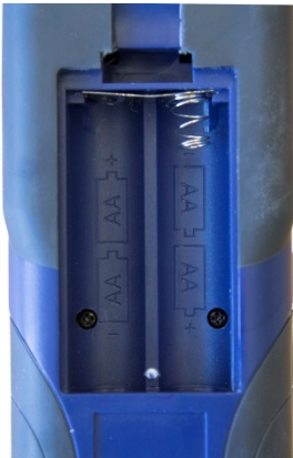
Fig. 21: Vano pile aperto
