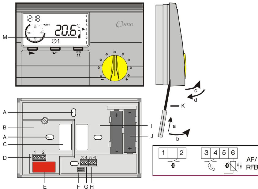
B Anschlußraum für Netzspannung
