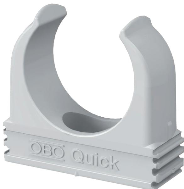
OBO Quick-Schelle Typ 2955/...: für alle metrischen Stahlpanzerrohre, sowie leichte und schwere metrischen Isolierrohre. Geeignet zur Aufnahme der OBO Quick-Pipe. Rohrzentrierhilfen ermöglichen ein optimales Einbringen des Rohres und verdrehen automatisch die Schelle in die richtige Position.
