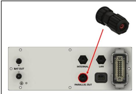
Wenn nur ein Batterieturm installiert wird, muss am Anschluss PARALLEL OUT die Endbrücke (im Lieferumfang enthalten) eingesteckt und durch Drehen der Unterseite verriegelt werden.
