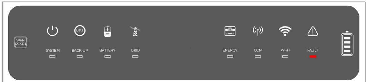
Abbildung 19: Störungsanzeige am Home - Wechselrichter
