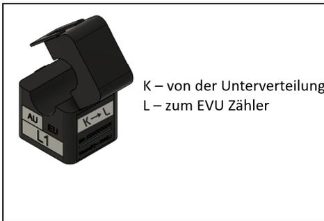
10. Kontrolle des Anschlussbereiches der Klappwandler
