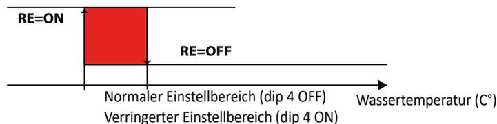
Wird der Gebläsekonvektor bei Erreichen des Sollwertes mit kontinuierlicher Lüftung betrieben, wird der elektrische Widerstand abgeschaltet, während die Lüftung nach der nachfolgend beschriebenen Nachlüftungsphase mit der Drehzahl V1 weiterläuft
