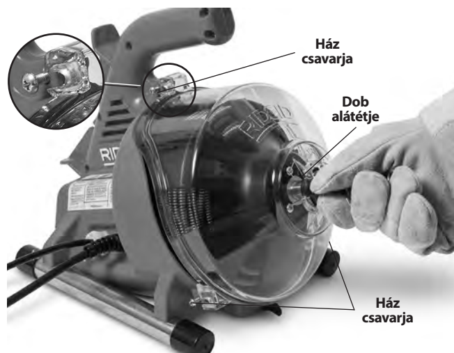
13. ábra – A lefolyótisztító gép felnyitása
