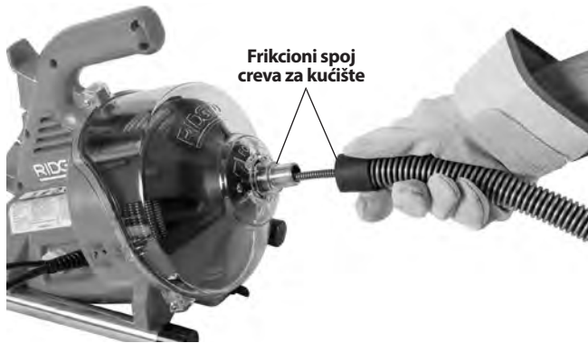
Slika 4 – Uvođenje sajle u crevo za navođenje
