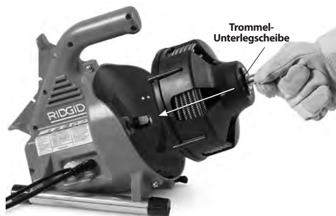
Abbildung 16 – Einsetzen der Trommel in die Maschine
