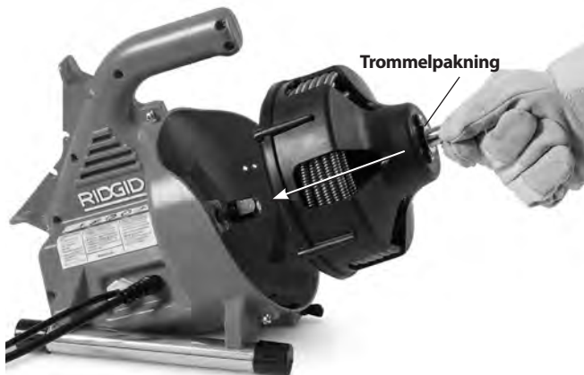
Figur 16 – Sette trommelen inn i maskinen
