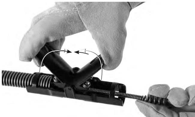
Slika 5 – Provođenje sajle kroz AUTOFEED® sklop
