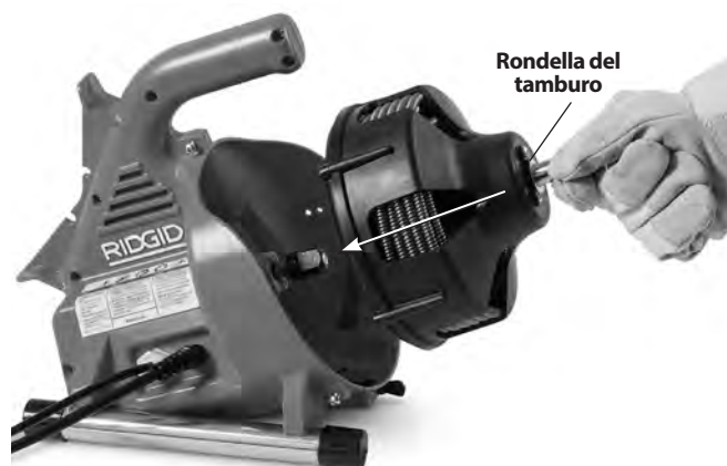
Figura 16 – Inserimento del Tamburo nella Macchina
