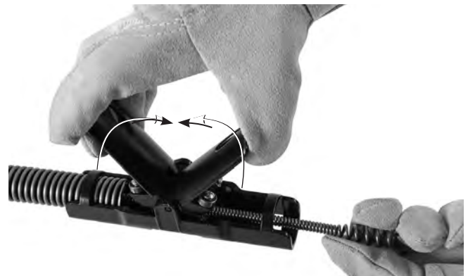
Figura 5 – Avançar o cabo através da montagem AUTOFEED®
