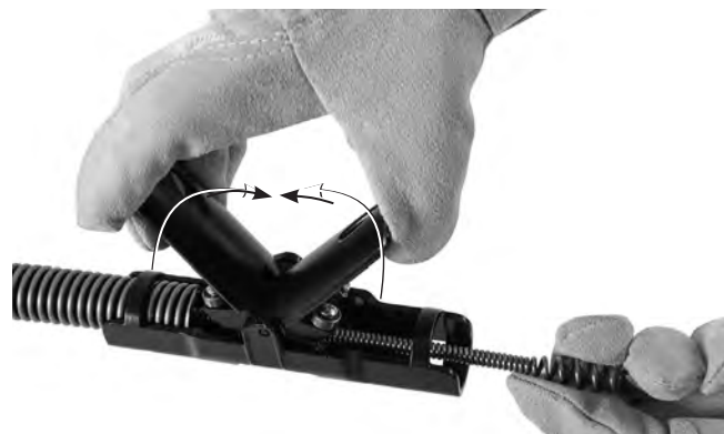
Figura 5 – Avansarea cablului prin ansamblul AUTOFEED®
