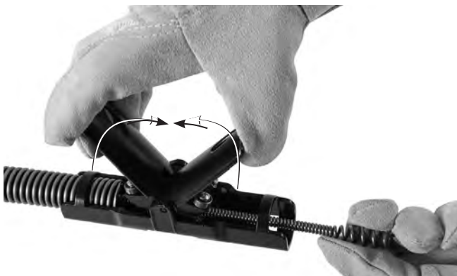
Kuva 5 – Jousen syöttäminen AUTOFEED®-kokoonpanon läpi
