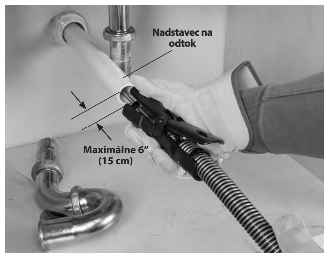
Obrázok 7 – Príklad rozšírenia odtoku max. 6" (15 cm) od jednotky AUTOFEED.
