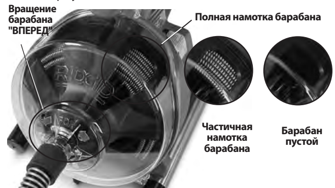
Рис. 10 – Контроль троса в барабане
