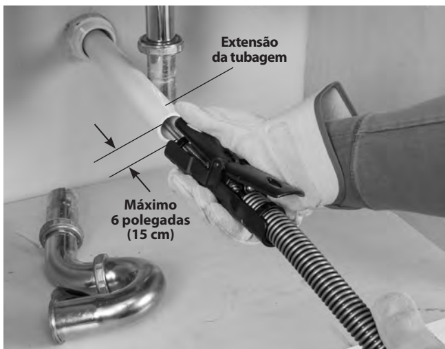
Figura 7 – Exemplo de estender a tubagem até 6 polegadas (15 cm) da unidade AUTOFEED.
