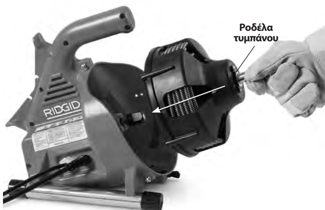
Εικόνα 16 – Τοποθέτηση του τύμπανου στο μηχάνημα
