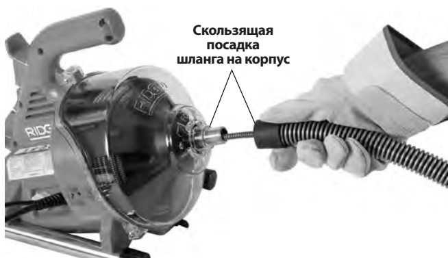
Рис. 4 – Подача троса в направляющий шланг
