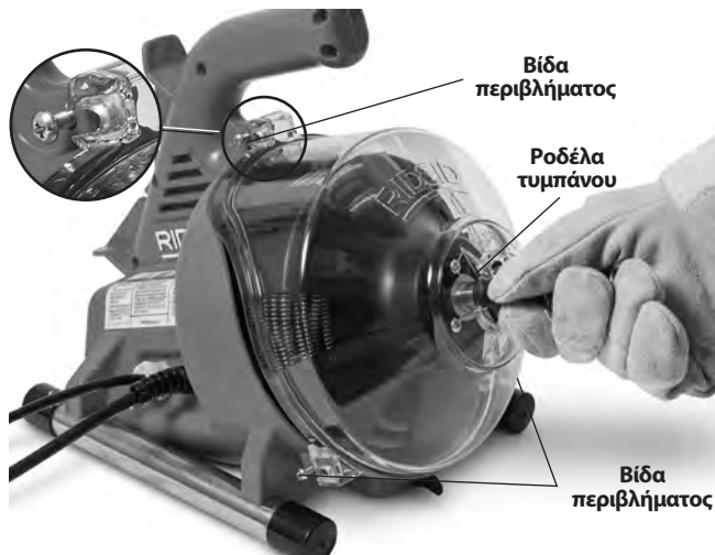
Εικόνα 13 – Άνοιγμα του μηχανήματος απόφραξης αποχετεύσεων
