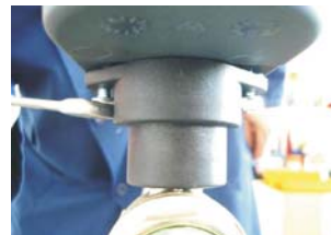
Stelen Sie den Antrieb zurück und verschrauben ihm (Gabelschlussel 10mm), M=2..2.5Nm
