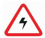
Hinweis: Gefahr durch elektrische Spannung
