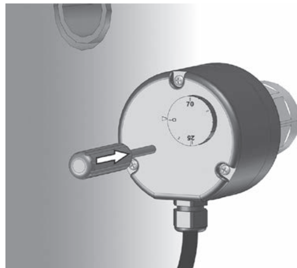
Figure 17: Déblocage à l'aide d'un tournevis
