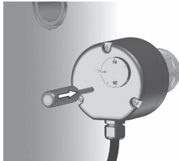
Abbildung 17: Entriegelung mit Schraubenzieher
