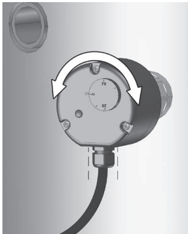
Figure 13: Aligner le presse-étoupe de câble
