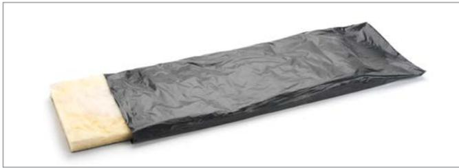
Abb. 5-9 PE-gekapselte Mineralfaser
