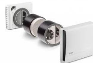
Der COSMO-ECO-DUO ist ein Zu- und Abluftgerät mit Wärmerückgewinnung, welcher für die Montage in Funktionsräumen (Bad, Küche, WC) Ihrer Wohnung/ Ihres Hauses konzipiert ist. Diese Geräte sorgen dafür, dass verbrauchte und feuchtebelastete Luft ausgetauscht oder abtransportiert wird. Dabei arbeitet die Wärmerückgewinnung äußerst effizient.
