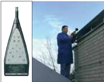
Jede Schallmessung wird mit Schallpegelmessgeräten der Klasse 1 durchgeführt.
