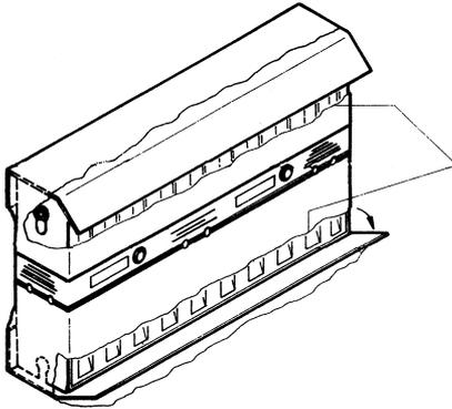
**Wichtig!** Der Flachheizkörper (FHE) kann mit Verpackung montiert und angeschlossen werden.
